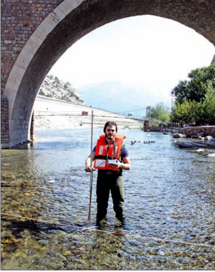
Muline ile büyük nehirde hız ölçümü
