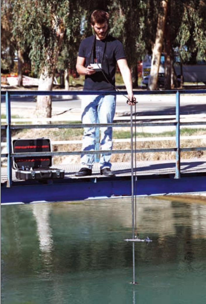
Muline ile büyük kanalda hız ölçümü
